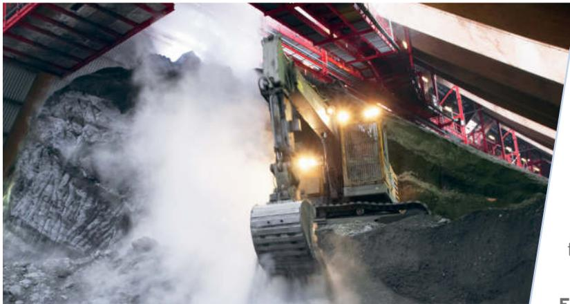
Die Rostschlacke wird im Entschlacker mit Zusatzwasser gewaschen, um den Gehalt an leicht löslichen Salzen zu reduzieren. Die Schlacke wird gesiebt und gebrochen sowie von nicht verbrannten Bestandteilen befreit, um einen geprüften und zugelassenen Baustoff, vergleichbar mit einem Mineralgemisch aus aufbereitetem Bauschutt, zu produzieren. Die nicht verbrannten Bestandteile der Schlacke werden in den Müllbunker zurückgebracht und durchlaufen erneut den Verbrennungsprozess.
