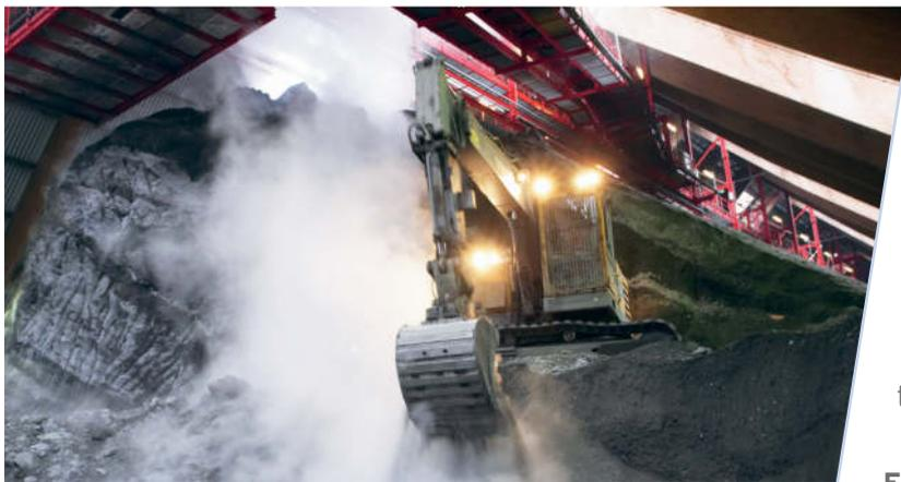
Die Rostschlacke wird im Entschlacker mit Zusatzwasser gewaschen, um den Gehalt an leicht löslichen Salzen zu reduzieren. Die Schlacke wird gesiebt und gebrochen sowie von nicht verbrannten Bestandteilen befreit, um einen geprüften und zugelassenen Baustoff, vergleichbar mit einem Mineralgemisch aus aufbereitetem Bauschutt, zu produzieren. Die nicht verbrannten Bestandteile der Schlacke werden in den Müllbunker zurückgebracht und durchlaufen erneut den Verbrennungsprozess.
